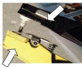
Poser le tube sur l'aiguille et fermer la pince jusqu'à entendre un clic. Appuyer sur le verrou situé sur le côté de la pince. Retirer l'ensemble aiguille+tube
